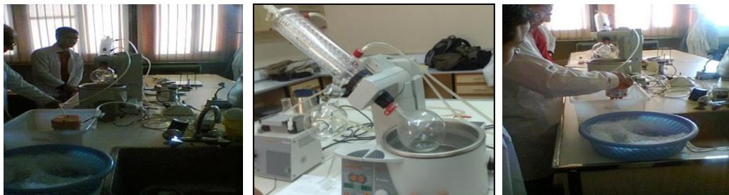
تصویر ۵. دستگاه rotary evaporator که جهت خالص سازی و تقطیر هورمون‌ها استفاده می‌شود.
